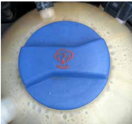
Kühlflüssigkeitsbehälter © Christian Gasche
